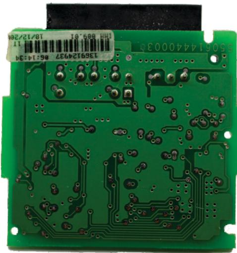
OBS.: VERIFICAR SE NOS PONTOS QUE SERÃO SOLDADOS EXISTE ALGUMA RESINA, CASO TENHA É NECESSÁRIO RASPAR COM CUIDADO UTILIZANDO UM CANIVETE.
