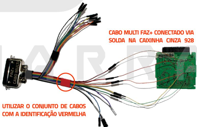
UTILIZAR O CONJUNTO DE CABOS COM A IDENTIFICAÇÃO VERMELHA
